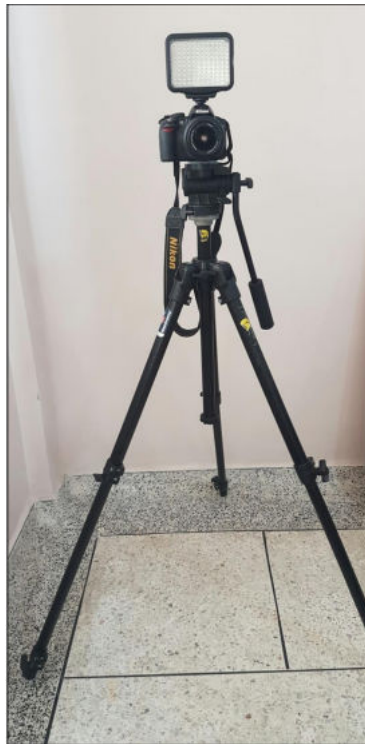
Fig. 1. Appareil photo avec la lampe d'éclairage monté sur un trépied ajustable
