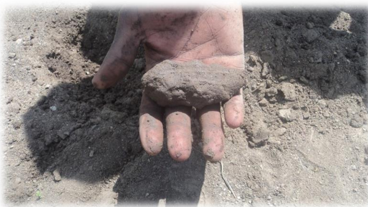
Fig. 6. L'écrasement d'un sol sec par la main
