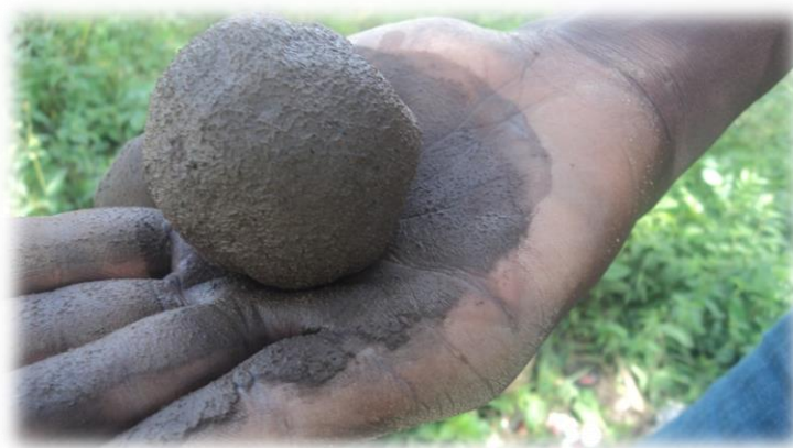
Fig. 3. Démonstration du test de la pression
