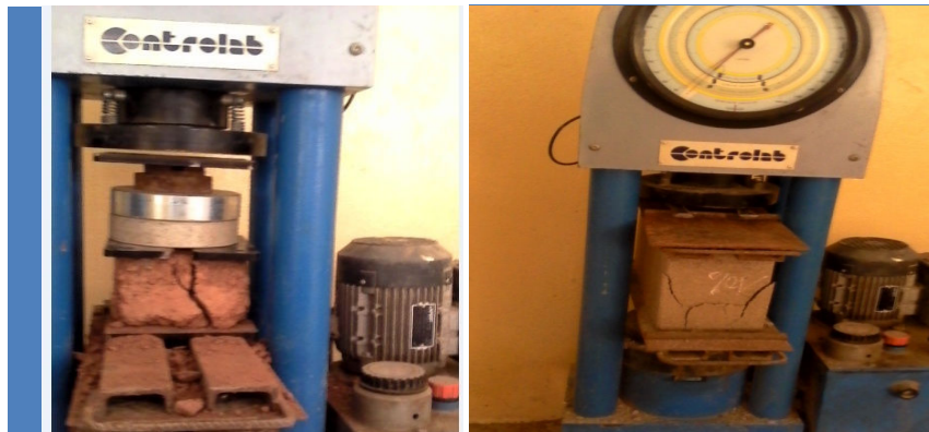
Fig. 7. Essai de Compression des briques en latérite et parpaing
