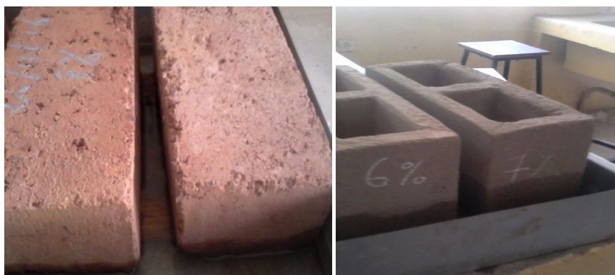
Fig. 9. Essai de succion par capillarité des briques en latérite et parpaing
