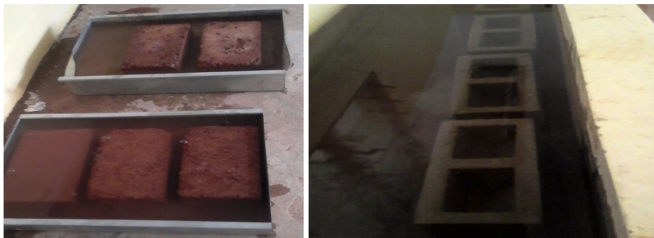
Fig. 8. Essai d'immersion des briques en latérite et parpaing
