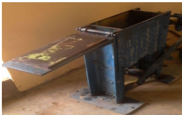
Fig. 5. Presse manuelle utilisée
