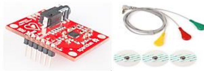
Fig. 3. Carte et sondes ECG [30], [32]
