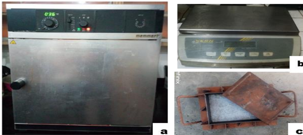
Fig. 2. Matériel de synthèse et de mise en œuvre: (a) Etuve (b) Balance (c) Moule
