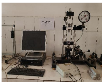
Fig. 1. Machine d'essai universelle WP 300 pour essai de traction
