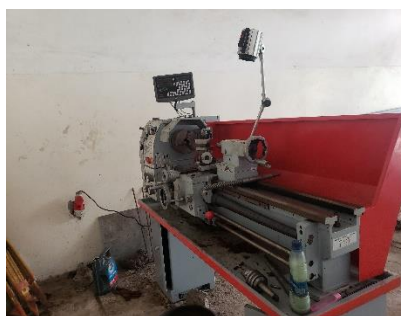
Fig. 2. Machine-outil tour pour la fabrication des Eprouvettes
