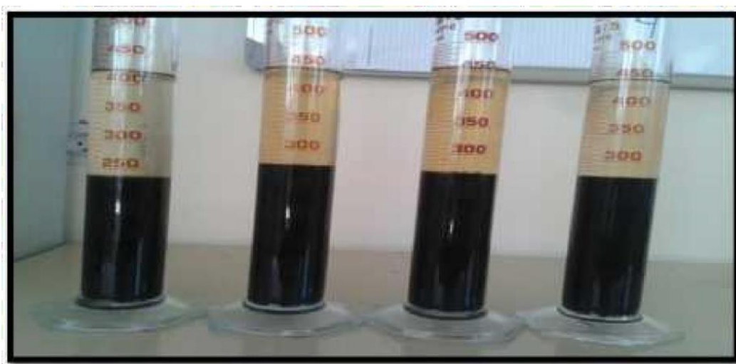
Fig. 9. Volume des boues décantées dans le traitement au \text{FeCl}_3
