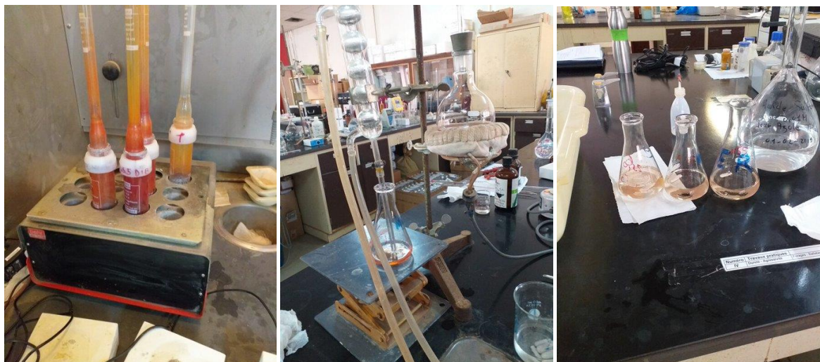
Fig. 6. Minéralisation, distillation et titrage de l'azote de Kjeldahl
