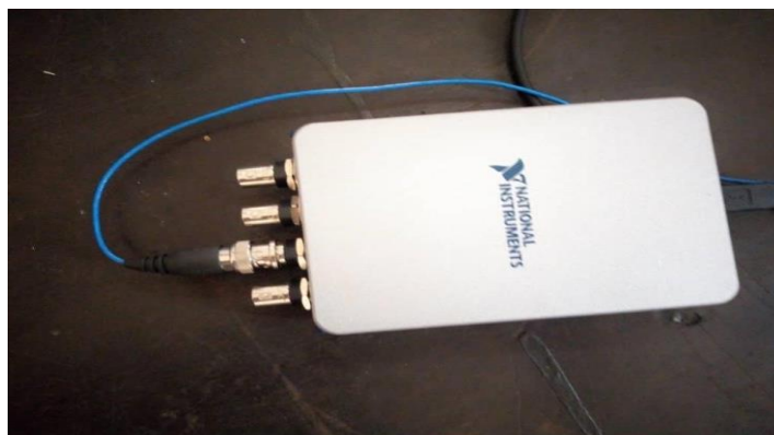
Fig. 5. Système d'acquisition cDAQ avec module 9215
