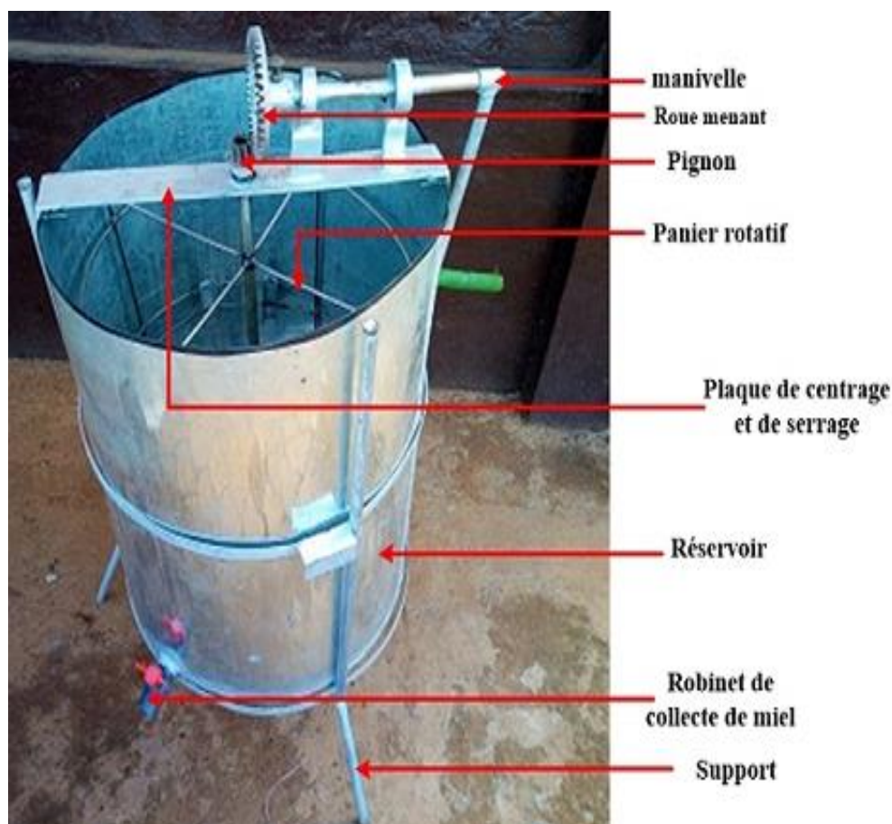
Fig. 10. Extracteur centrifuge radial de miel fabriqué
