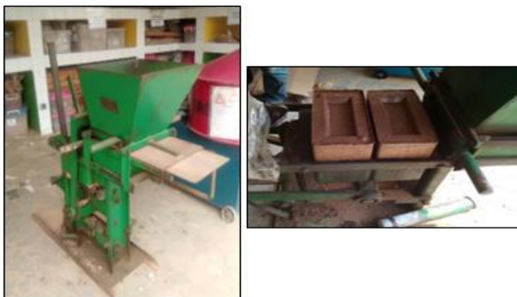
Fig. 2. Presse hydraulique avec le moule de compactage
