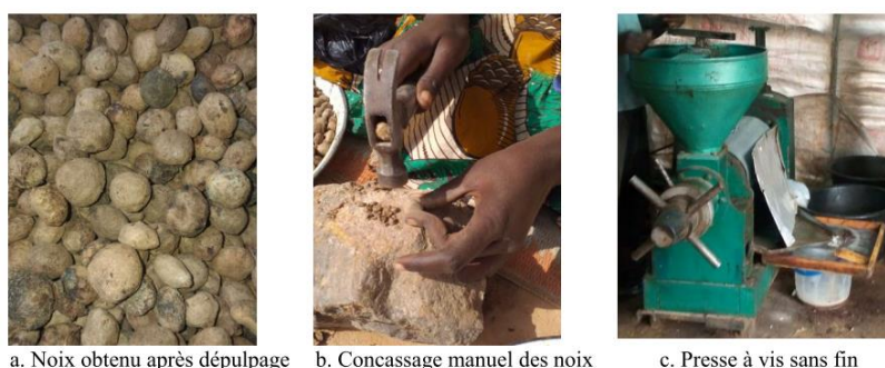
a. Noix obtenu après dépulpage b. Concassage manuel des noix c. Presse à vis sans fin
