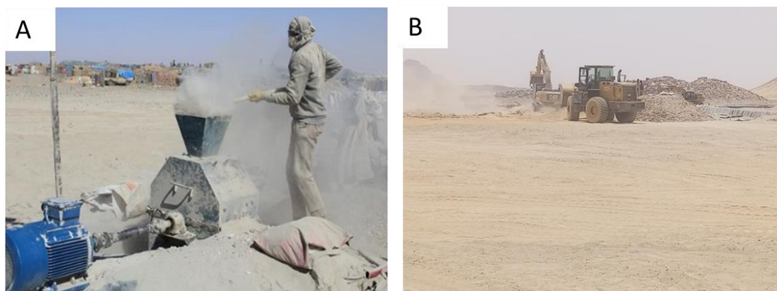
Fig. 10. Emission de poussière lors du concassage du minerai (A) et du chargement du bassin de cyanuration (B) [19]
