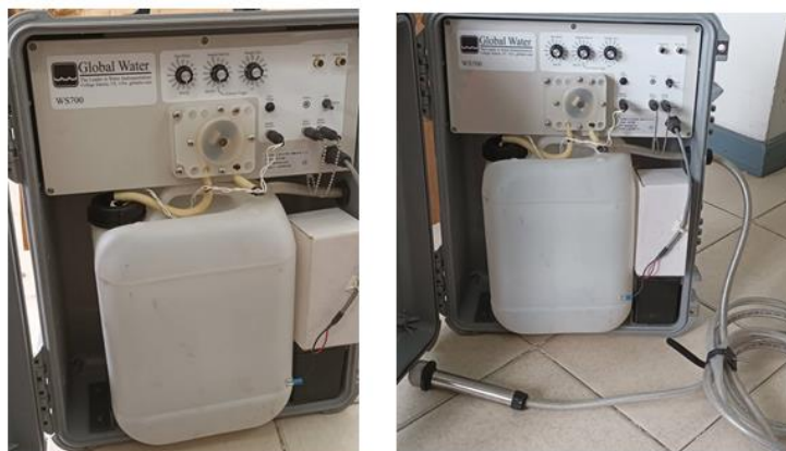
Fig. 6. Kit d'échantillonneur d'eau utilisé pour le prélèvement d'échantillons d'eaux du fleuve Congo (photo Masua, 2022)
