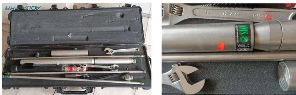
Fig. 5. Echantillonneur de sédiments utilisé lors du prélèvement des sédiments dans le fleuve Congo (photo Masua, 2022)
