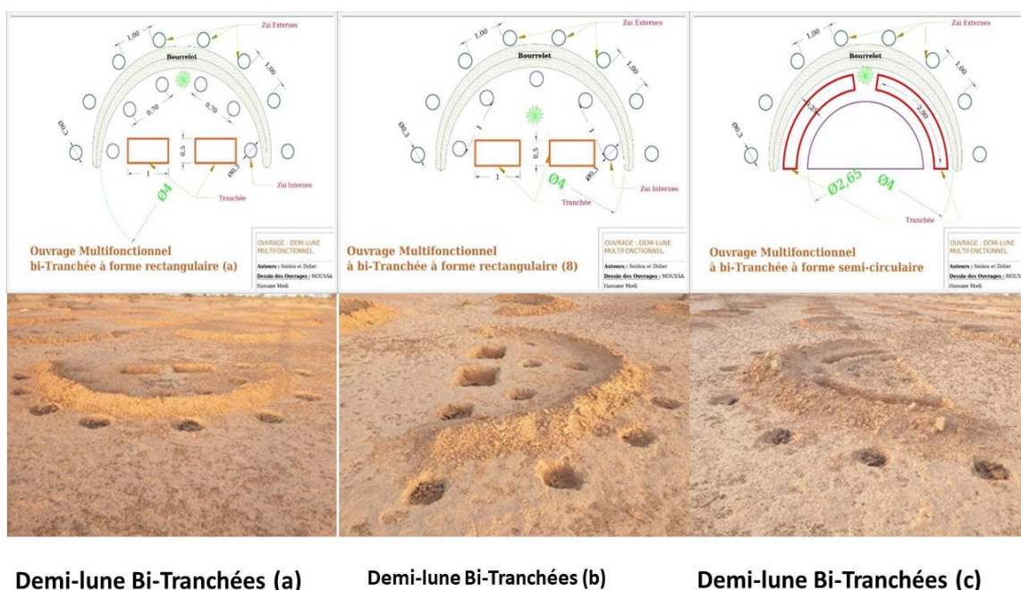
Fig. 8. Vue du type de demi-lunes à « bi-tranchées »
