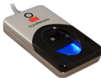
Fig. 1. Scanner biométrique d'empreinte digitale modèle U.are.U 4000b
