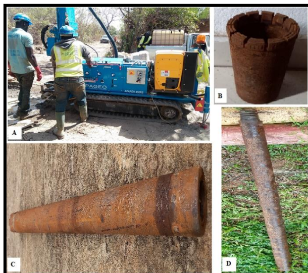
Fig. 2. Matériel de réalisation d'un sondage carotté A: Sondeuse APAFOR 450, B: une couronne; C: carottier rotatif; D: tige de carottage
