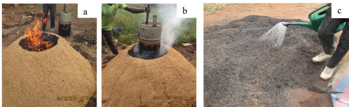
Fig. 3. Etapes de carbonisation des résidus agroindustriels
