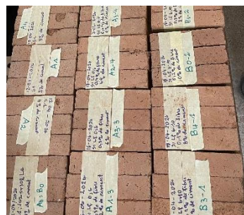
Fig. 4. Briquettes 4x4x16 cm 3
