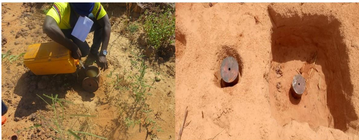
Fig. 4. Vue du test d'infiltration réalisé au niveau d'un zaï et dans une cuvette à l'aide d'anneau simple
