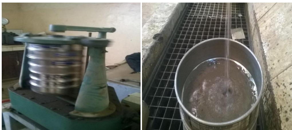
Fig. 7. (a) Tamisage des refus de 45µm sur le rotape et (b) Tamisage à l'eau
