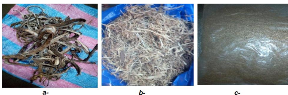
Fig. 3. a- Vue des écorces de Grewia Venusta enlevées de l'arbre b- Vue des fibres des écorces de Grewia Venusta c- Vue de la poudre des écorces de Grewia Venusta
