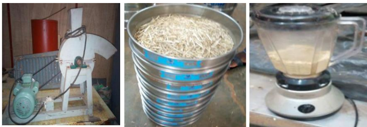
Fig. 4. a- Vue du broyeur mécanique b- Vue de la série de tamis c- Vue de la moulinette
