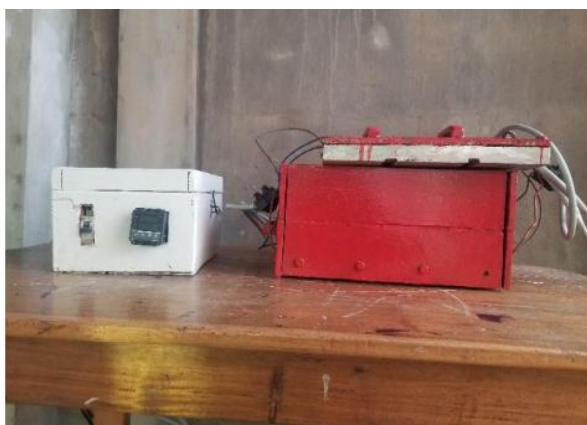
Fig. 7. Vues de la moule thermique réalisée pour la confection des échantillons
