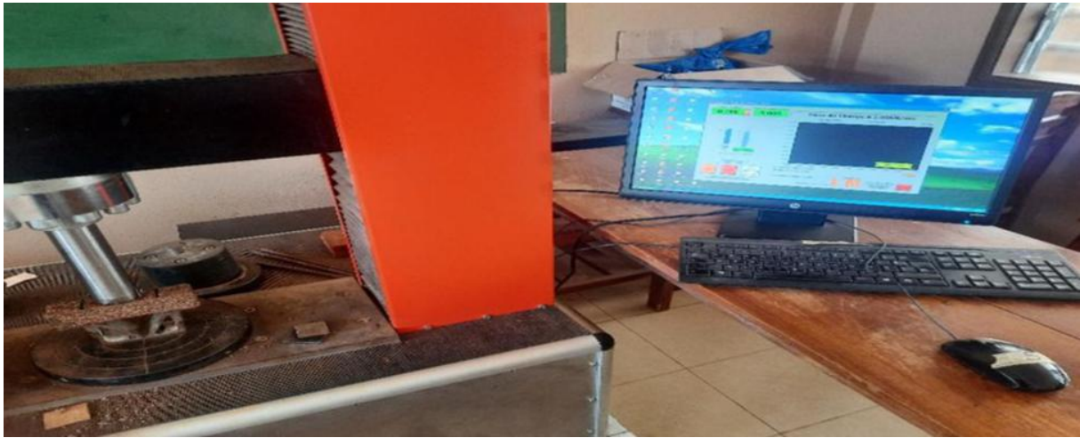
Fig. 9. Presse mécanique équipée d'un ordinateur d'acquisition de données
