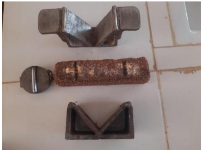
Fig. 10. Eléments du Dispositif de flexion 3 points
