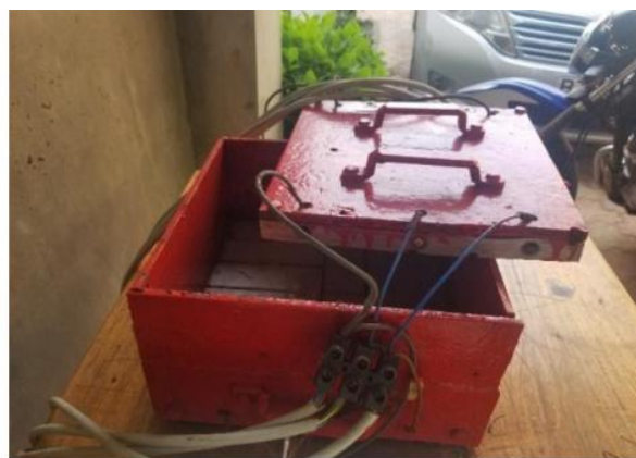
Fig. 7. Vues de la moule thermique réalisée pour la confection des échantillons
