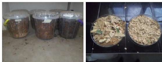
Fig. 1. Techniques de prétraitement montrant (a) le traitement biologique: feuilles de neem mélangées à la bouse fraîche de vache, (b) le traitement mécanique: feuilles de neem émiettées en particules de 4 mm.
