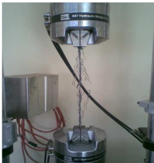
Fig. 3. Essai de traction sur une éprouvette de câble
