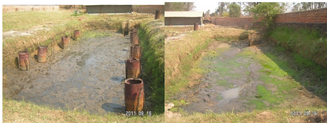
Photo 1: Etang avec fûts pour le chauffage de l'eau (à gauche) et étang sans système de chauffage (à droite).
