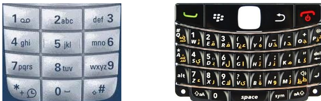
Fig. 1. Claviers téléphoniques : (clavier standard monoscriptural Nokia à douze touches à gauche, clavier mini-QWERTY biscriptural (latin et arabe) BlackBerry à droite).
