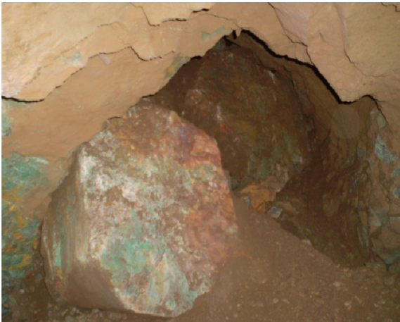
Fig. 5. Chute de bloc dans les chambres en exploitation.
