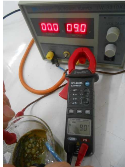
صورة (2) استخدام مستوى 9 فولت على خفض الكتلة الحية للطحالب
