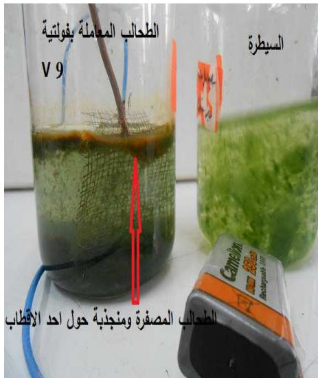
صورة (2) استخدام مستوى 9 فولت على خفض الكتلة الحية للطحالب
