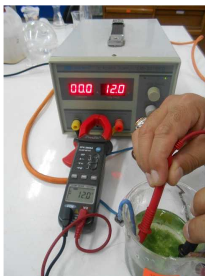
صورة (1) استخدام مستوى 12 فولت على خفض الكتلة الحية للطحالب
