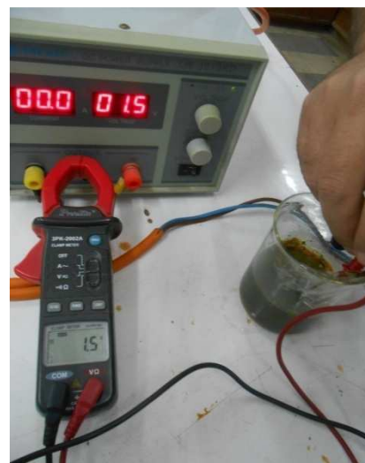
صورة (6) استخدام مستوى 1.5 فولت على خفض الكتلة الحية للطحالب
