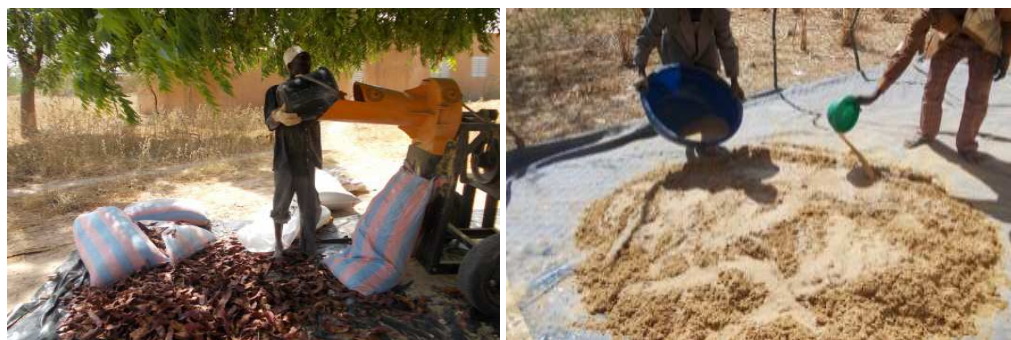
Figure 2: Broyage (à gauche) des ingrédients grossiers et aspersion d'eau bouillante (à droite) du mélange des ingrédients pesés pour la fabrication des blocs multi-nutritionnels concentrés.
