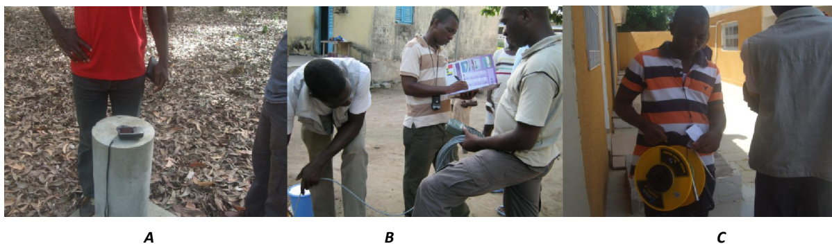
Fig. 2. Matériel utilisé : A : GPS utilisé sur un point géodésique + Point géodésique ayant servi à l'étalonnage du GPS; C : Appareil multi paramètres utilisé pour la détermination des paramètres physiques in situ. B : Sonde piézométrique.
