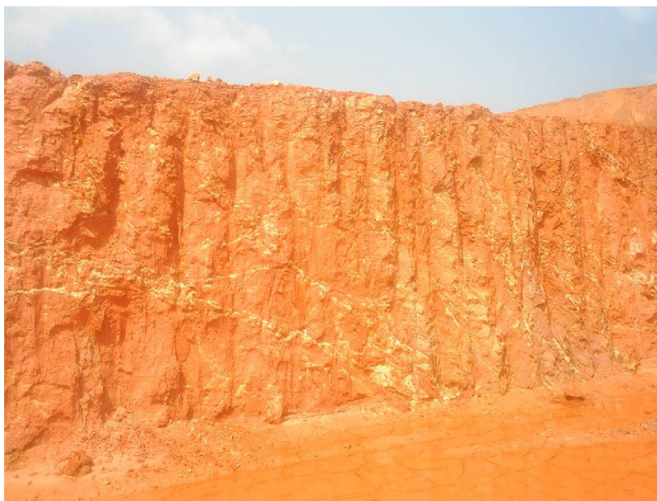
Fig 12. Affleurement d'altérites latéritiques rouges vifs avec des filons entrecroisés sur le site du cet de Kossihouen
