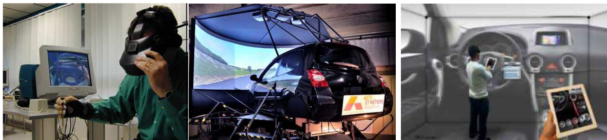
Fig. 4. Un visiocasque (à gauche), Simulateur de conduite dynamique (SAAM) installé à l'institut image Arts et Métiers ParisTesch (au centre), Salle immersive le Move installé à l'institut image Arts et Métiers ParisTesch (à droite)
