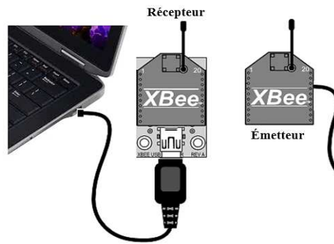
Fig. 7. Interfaçage du XBee récepteur au PC par liaison USB via un adaptateur
