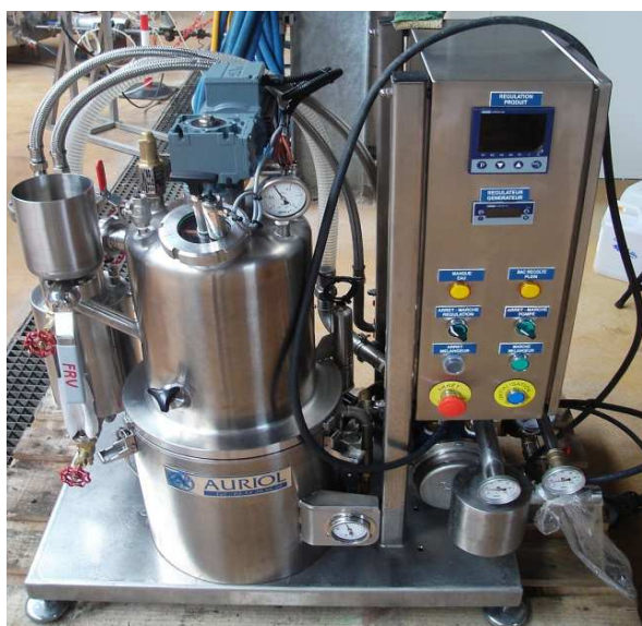
Fig. 3. Boule de concentration sous vide de marque AURIOL
