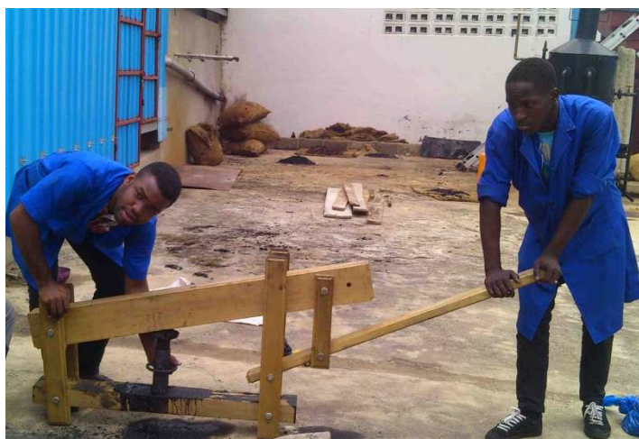
Fig. 3. Presse à levier en bois dimensionnée et fabriquée à l'IUT de Lokossa
