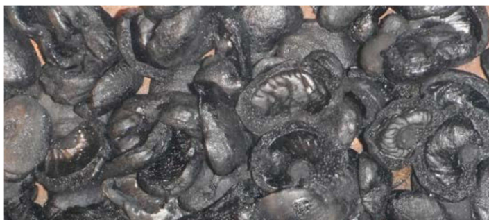
Fig. 2. Biocharbons issus de la pyrolyse des coques d'anacarde au Bénin
