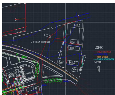
Figure 10: Carte obtenue sur Autocad des différents utilitaires détectés dans le site de recherche
