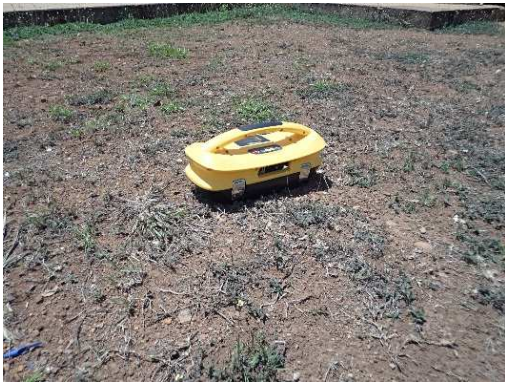
Photo 3: Vue de l'Émetteur du VlocPro2, pose au sol lors des travaux de prospection sur terrain
