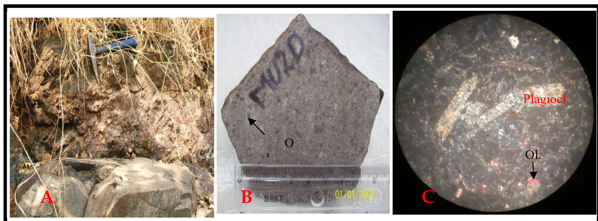
Fig. 4. (A) Affleurement des basaltes dans la région de Mbuji-Mayi. (B) vue macroscopique des phénocristaux d'olivine dans une roche basaltique. (C) Pyroxènes et plagioclases contenus dans le basalte avec une texture subophitique à microlithique porphyrique. On y observe des microphénocristaux d'olivine et d'albite en voie d'altération.
