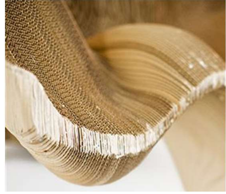
صورة (10) خامه الكرتون المضغوط المصنوع منها المقعد (bengtsson 2003)
