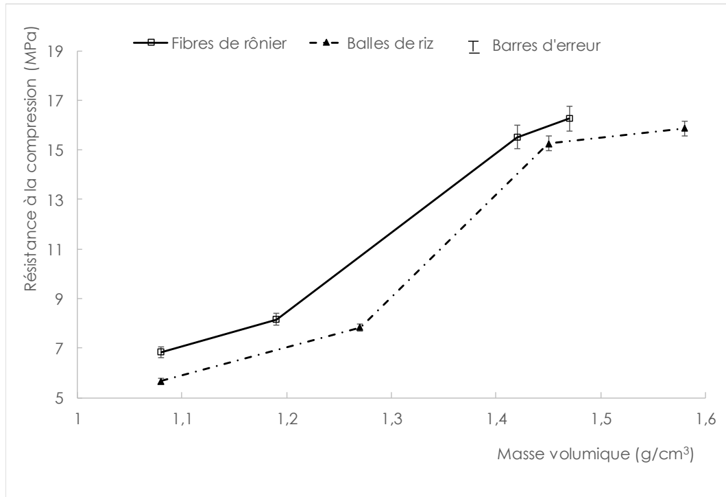
Fig. 3. Résistances à la compression en fonction de la masse volumique des composites étudiés
