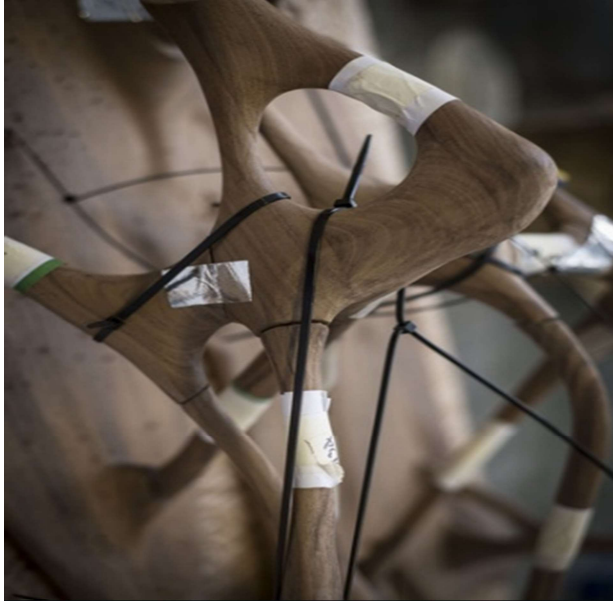
صورة (20) توضح تركيب الأجزاء معا باستخدام شرائط بلاستيكية (bengtsson 2014)
