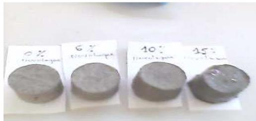
**Fig. 3. Photographie des matrices des essais (réf, 3,4 et 5)**
