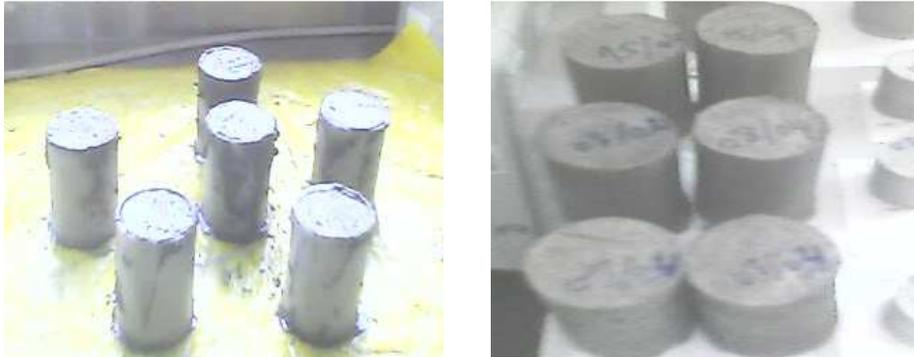
**Fig. 13. Photographie de la matrice de l'essai 16 à 1,48 % de polymère**
