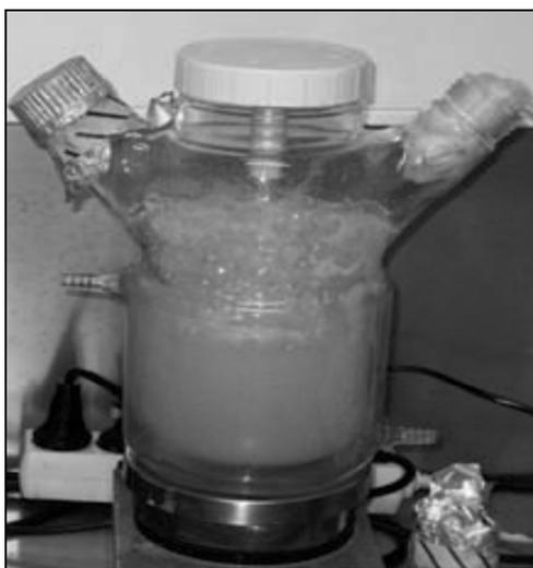
Fig. 2 : Bioréacteur utilisé pour la biodégradation de l'effluent laitier
