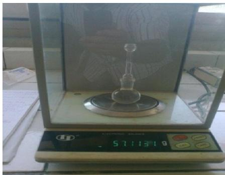
Fig. 2. Photo du pycnomètre
