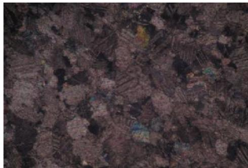
*Fig. 5. Aspect microscopique du marbre de Bou-Acila observé en lumière polarisée et analysée (x4).*
