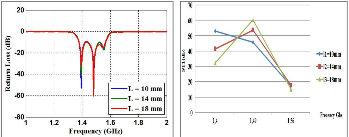
Fig.4. Investigate parameter  $L_1$  (varies  $L_1$ ,  $g=0.5$ mm,  $L_2=0.5$ mm)
