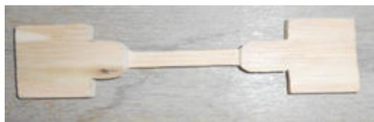
Figure.3 : Géométrie de l'éprouvette de traction.
