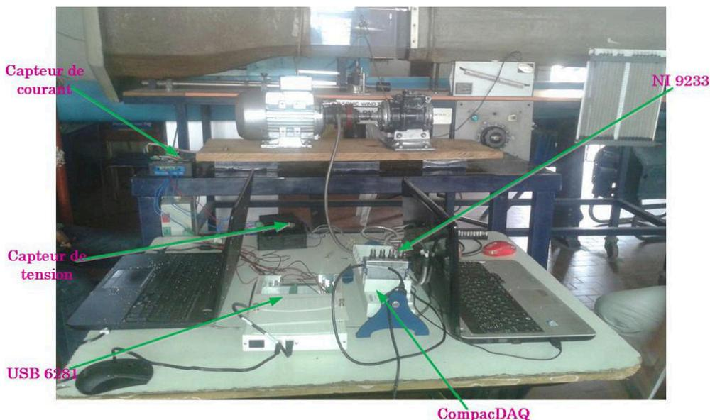
Fig. 2. Système d'acquisition des signaux
