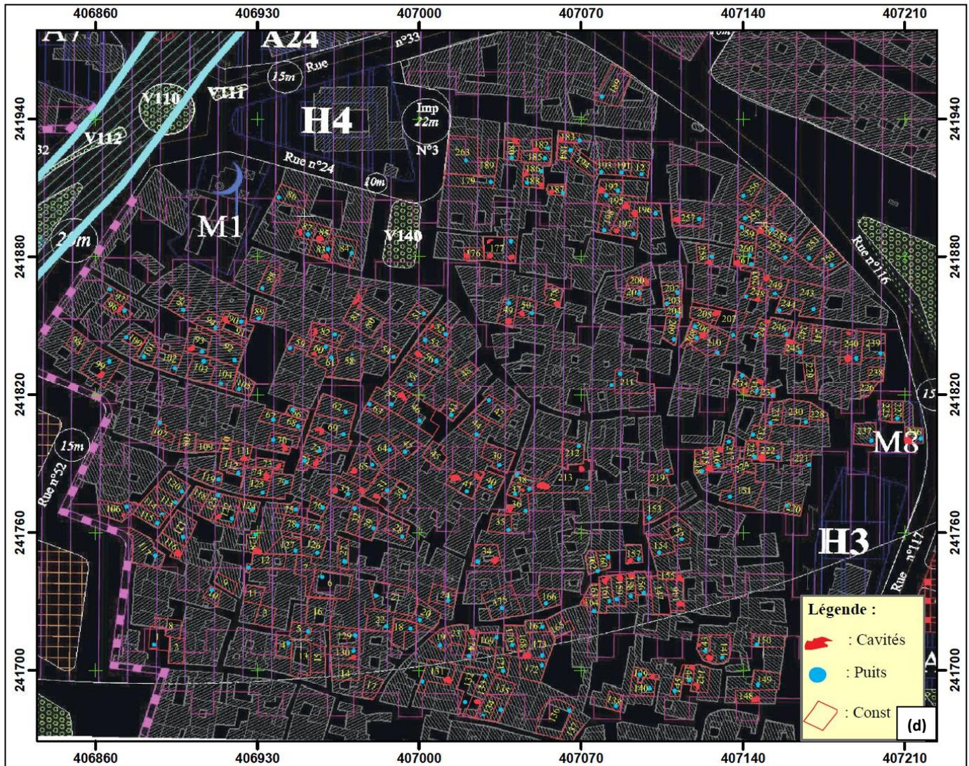
Fig. 9. Cartographie des cavités souterraines détectées à travers les zones (a, b, c et d) couvrant la totalité de l'ancienne médina de Boujad
