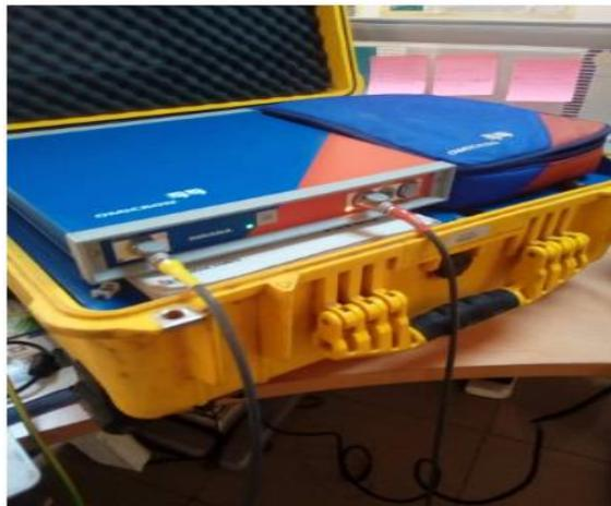
Fig. 6. Appareil de mesure diélectrique: Le DIRANA (CIE)
