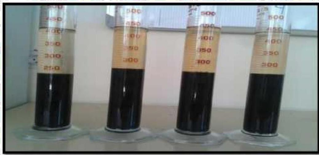
**Fig. 9. Volume des boues décantées dans le traitement au FeCl<sub>3</sub>**
