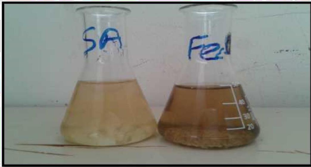
**Fig. 12.** *Echantillons de margine traitée par le sulfate d'aluminium et le chlorure Ferrique*
