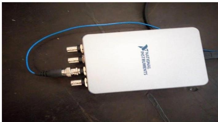
**Fig. 5.** Système d'acquisition cDAQ avec module 9215
