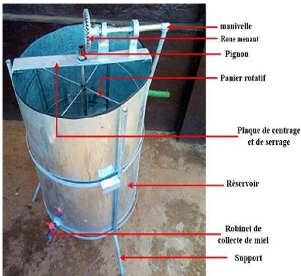
Fig. 10. Extracteur centrifuge radial de miel fabriqué
