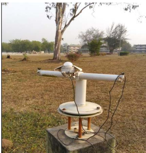
**Fig. 4. KIPP ZONEN Solarimeter**
