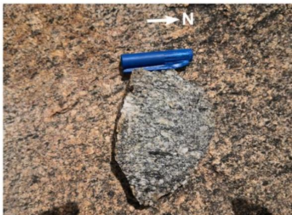
**Fig. 5.** Photographie montrant l'orientation et l'éirement des cristaux d'amphibole, de feldspaths et de biotite sur une granodiorite foliée.
