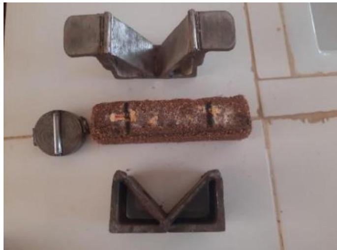
*Fig. 10. Éléments du Dispositif de flexion 3 points*
