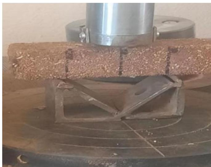
*Fig. 11. Dispositif de flexion 3 points*
